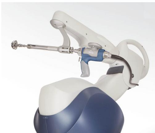
図84. 組み立てが完成したリーマーと電力設備
